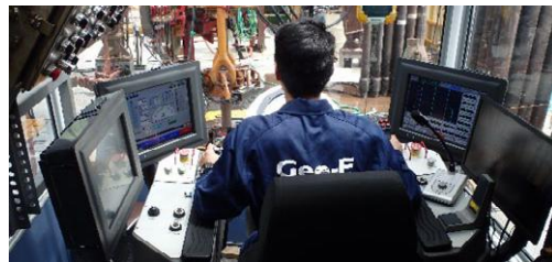
大型掘削リグ操作室内の様子 コンピュータ制御により掘削リグを操作する
